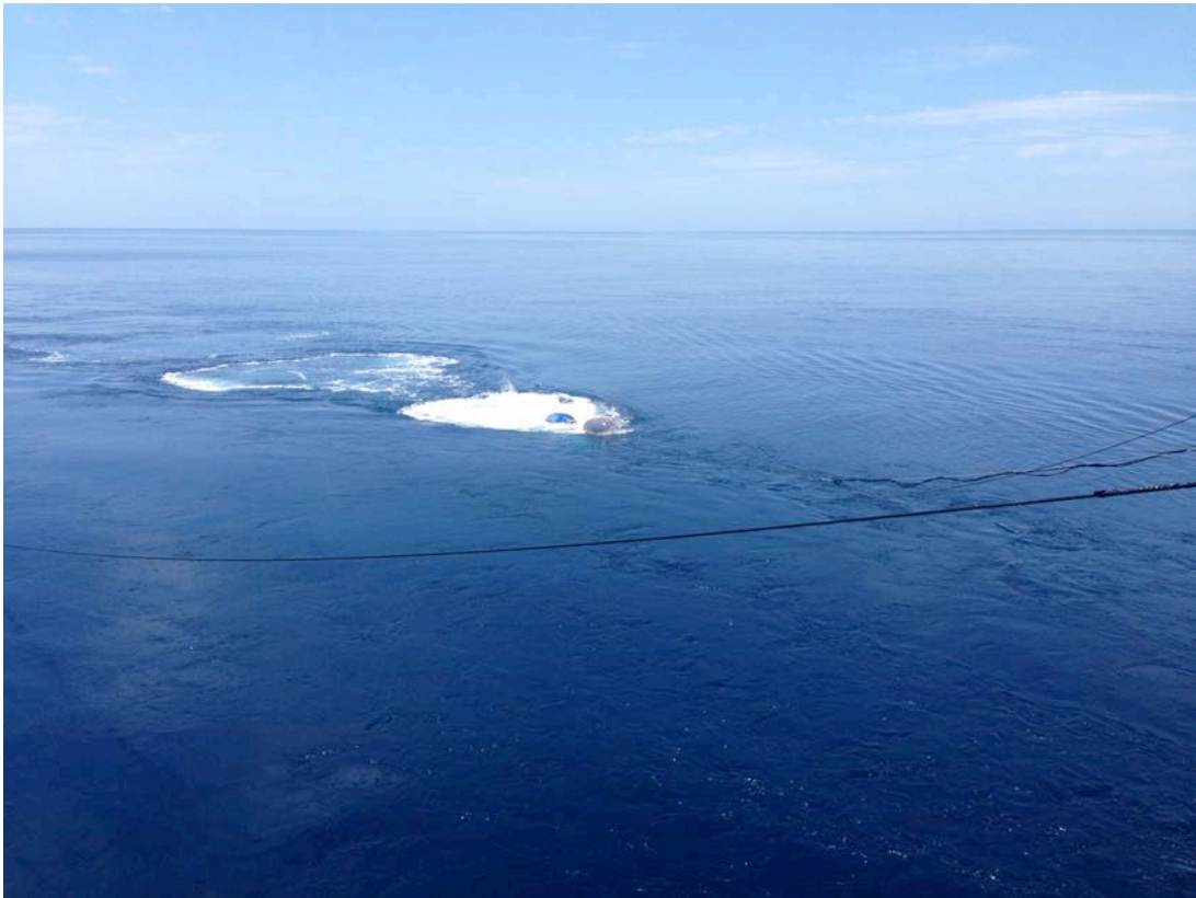
Stürmischer Golf von Kalifornien mit Luftpulsern (Air guns).
