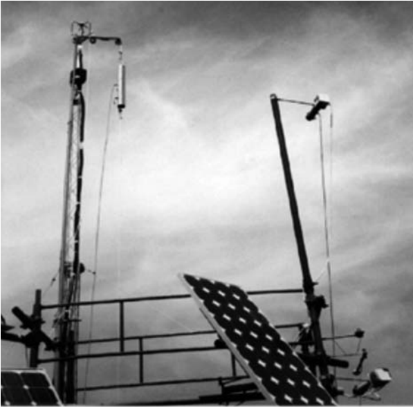
Figura 2: Fotografia del sistema REA usato per la misura dei flussi di BVOC in un bosco di leccio localizzato all'interno della Tenuta Presidenziale di Castelporziano.
