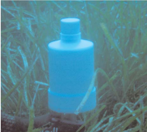
Figura 4: Il SuMaRad può essere utilizzato nello studio dell'attività biologica di piante e di alghe acquatiche, in relazione alla quantità e qualità della luce.
