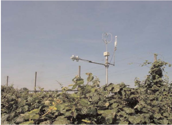
Figura 4: Strumentazione utilizzata per le misure dei flussi di CO 2 e H 2 O sull'actinidia nell'azienda Giuliani a S.Pietro in Vincoli (RA).
