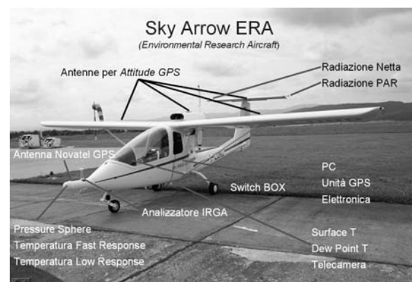
Figura 1. Il velivolo SkyArrow ERA e la strumentazione scientifica di bordo
