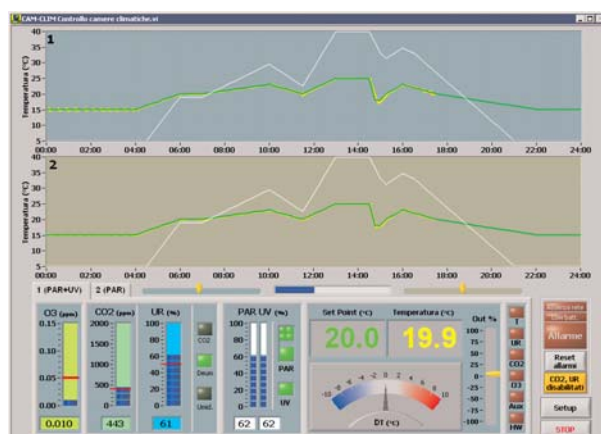
Figura 2: Schermata durante il normale funzionamento delle camere, in essa sono indicati i valori attuali, i set-point e le eventuali indicazioni di allarme.
