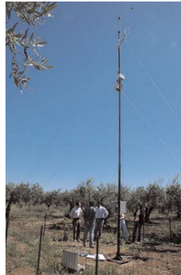
Figura 3: Strumentazione utilizzata per le misure dei flussi di CO 2 e H 2 O sull'oliveto Castelvetrano (TR).
