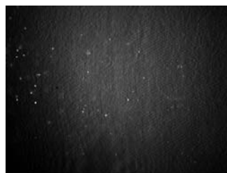
Figura 2: particelle di paraffina durante una prova di termoforesi in microgravità.
