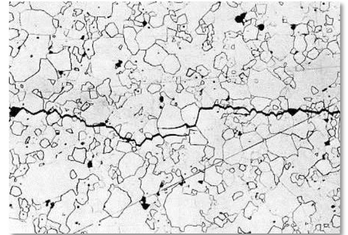
Propagation d'une fissure dans une alumine
