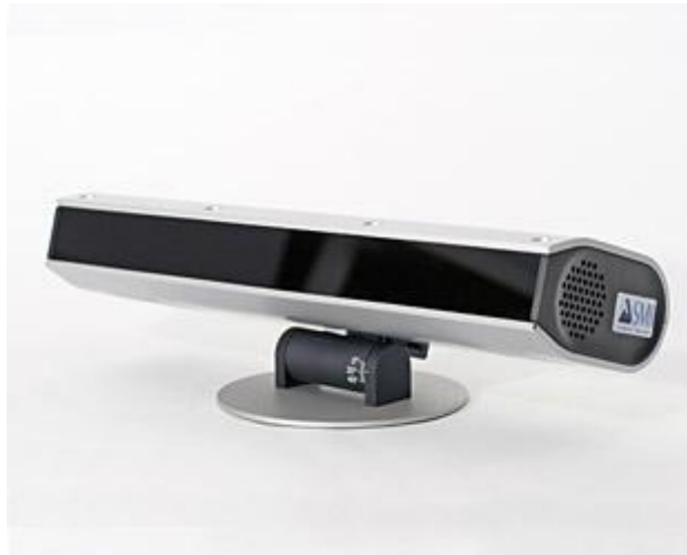
Figure 6 : Vue de l'Eye Tracker SMI RED250, utilisé dans les expériences du CAS (source: smivision.com)
