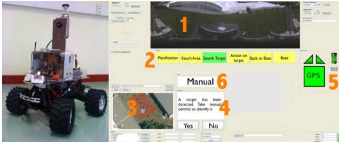
Figure 3 : L'image de gauche montre le robot développé par l'ISAE. L'image de droite représente la station sol de supervision et de pilotage du robot. Les parties critiques de l'interface sont numérotées : (1) écran de la vidéo panoramique, (2) synoptique, (3) carte Google tactique, (4) panneau de dialogue, (5) états du GPS, des ultrasons et de la batterie, (6) mode de pilotage du robot.)
