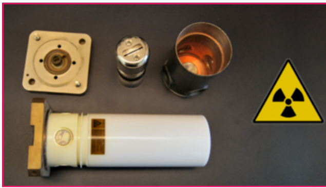
Figure 3 - Tubes scellés utilisés pour la production de rayons X et pictogramme « danger radiation ionisante ».
