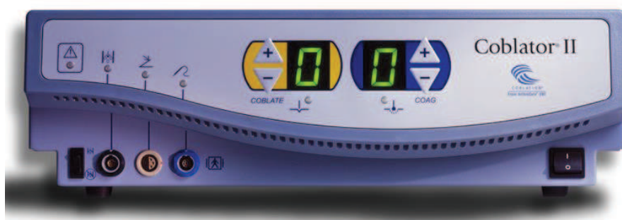
Figure 11 : Façade affichant les réglages de puissance de Coblation® et de coagulation [9]
