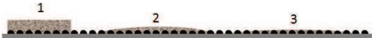
FIGURE 39 – Principe de l'expérience d'évolution spatio-temporelle d'un lâcher de sédiment sur un fond rugueux non érodable avec (1) l'état initial, (2) le déplacement avec apparition de zones où les rugosités non érodables émergent et (3) l'état final stationnaire avec le sédiment piégé entre les rugosités non-érodables.
