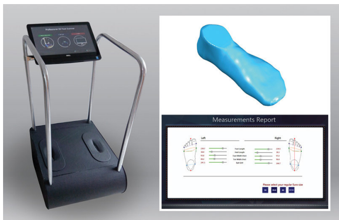
Slika 7. 3D skener stopala s prikazom mjernog i vizualizacijskog zaslona [10]
