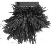
Slika 1. a) Ferotekućina i b) željezna piljevina u blizini stalnog magneta.
