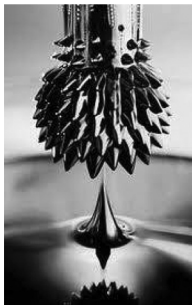
Slika 1. a) Ferotekućina i b) željezna piljevina u blizini stalnog magneta.
