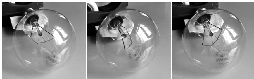
Slika 7. Lijevi položaj žarulje najjače grije donju površinu, srednji najmanje, a desni je negdje između.
