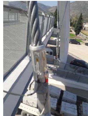
Slika 10. Mjerenje dilatacija podnožju AB luka Slika 11. Mjerenje dilatacija na jednoj zategi
