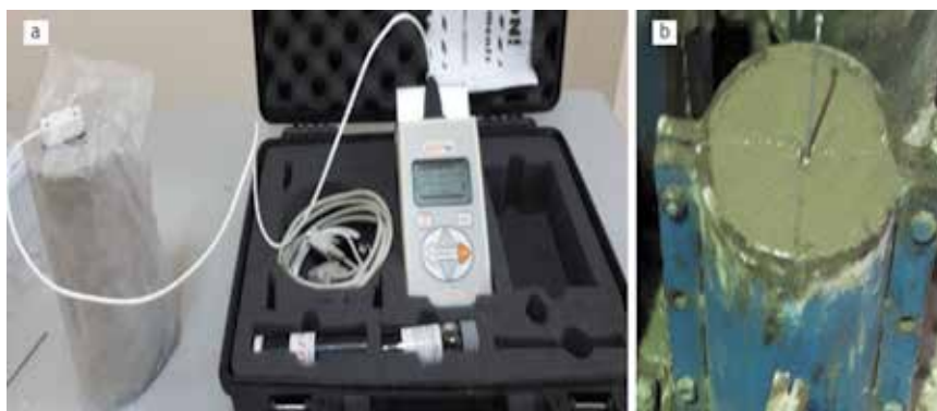
Slika 2. a) Pripremanje otvora za postavljanje senzora TR1; b) Mjerenje toplinske provodljivosti pomoću uređaja KD2-PRO
