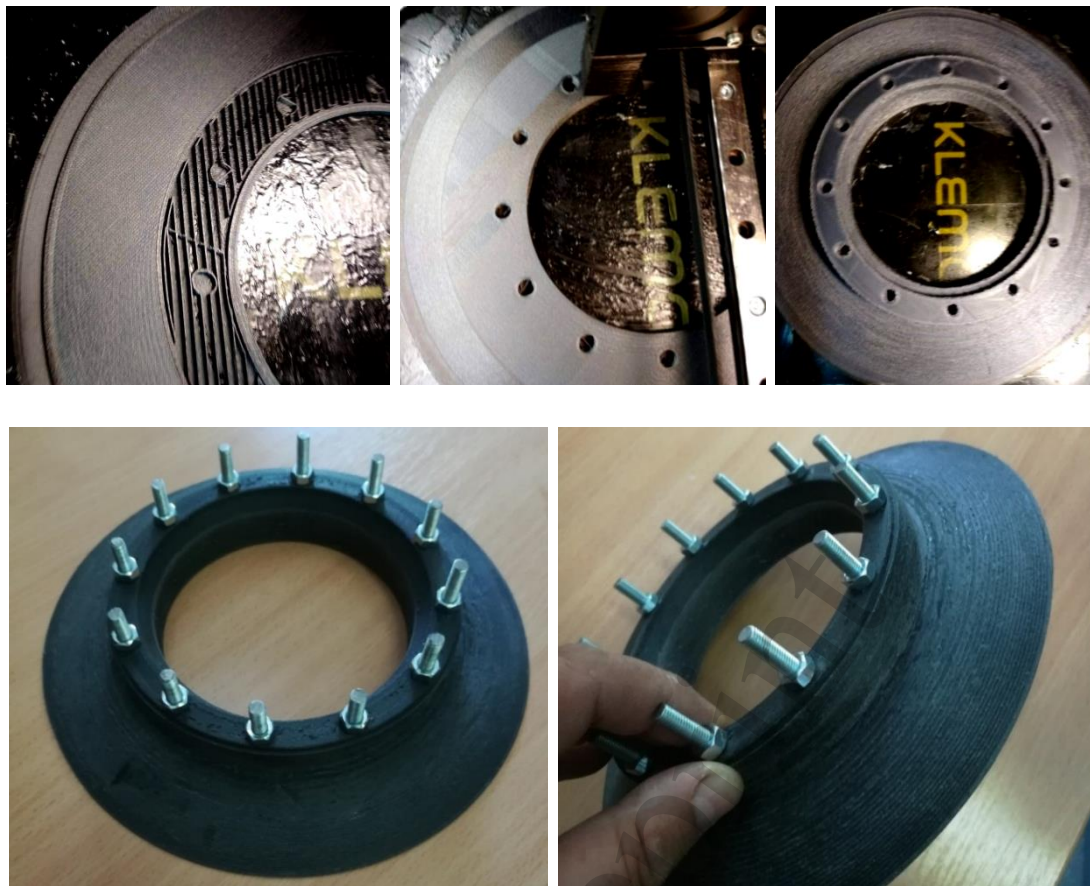
Рис. 11. Етапність відтворення фланців та отримані дослідні зразки
