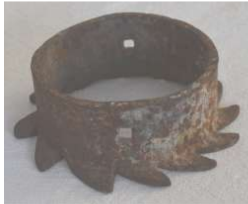
Figura 36. Il tipo di ruota dentata sulla quale agiscono nottolini per assicurare il ritegno del tamburo (da carri agricoli).
