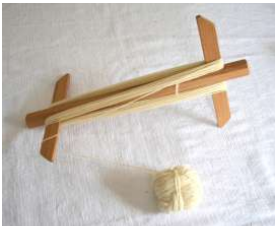
Figura 15. Dal gomitollo alla matassa: un aspo con il filo avvolto. Di facile messa a punto rispetto alla matassa originale, e con possibilità di sostituzione rapida.
