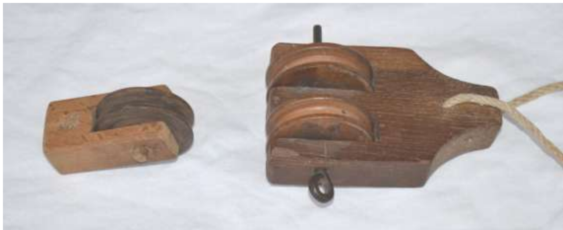
Figura 35. Una taglia per ridurre la forza di tiro (da un telaio per la tessitura): le cochlae lignae di Ammiano Marcellino [A-2]
