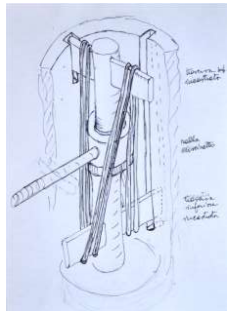
Figura 15. Dal gomitollo alla matassa: un aspo con il filo avvolto. Di facile messa a punto rispetto alla matassa originale, e con possibilità di sostituzione rapida.
