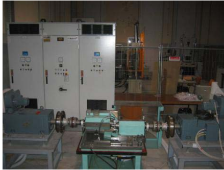
Figura 11. Banco prova sperimentale per misure di vibrazione, prove di resistenza e misure di efficienza in trasmissioni ad ingranaggi, realizzato in collaborazione con Case New Holland SpA presso DIMeC.
