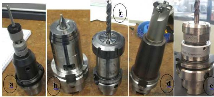
Figure 4. 2. Outils utilisés pour la préparation de la pièce (a) Palpeur (b) Foret à centrer (c) Foret diamètre 8 (d) Fraise torique à plaquette (e) Fraise à deux tailles monobloc
