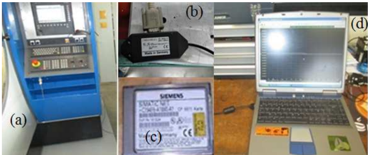
Figure 4. 12. Chaîne d'acquisition des signaux des vitesses d'avance (a) DCN (b) Câble et adaptateur (c) Carte d'acquisition (d) PC muni du logiciel SINUCOM
