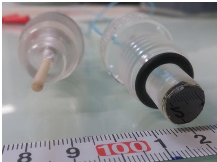
Figure V.6 : Photographie des électrodes fabriquées au laboratoire – double électrode travail/référence à gauche – contre électrode à droite
