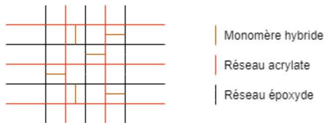
Figure 6: Représentation schématique d'un Graft-IPN.
