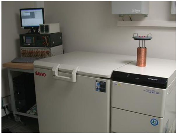
Fig. 97 HRTS-5760-B-U-0-12 sensor head
