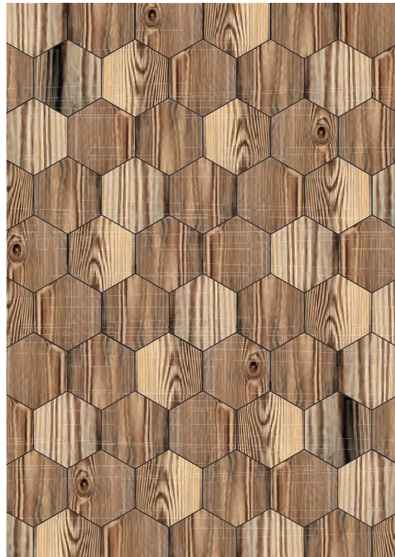
figur 77. Väggspanelens hexagonform. Panelen monteras överlappande, likt fjällpanel.
