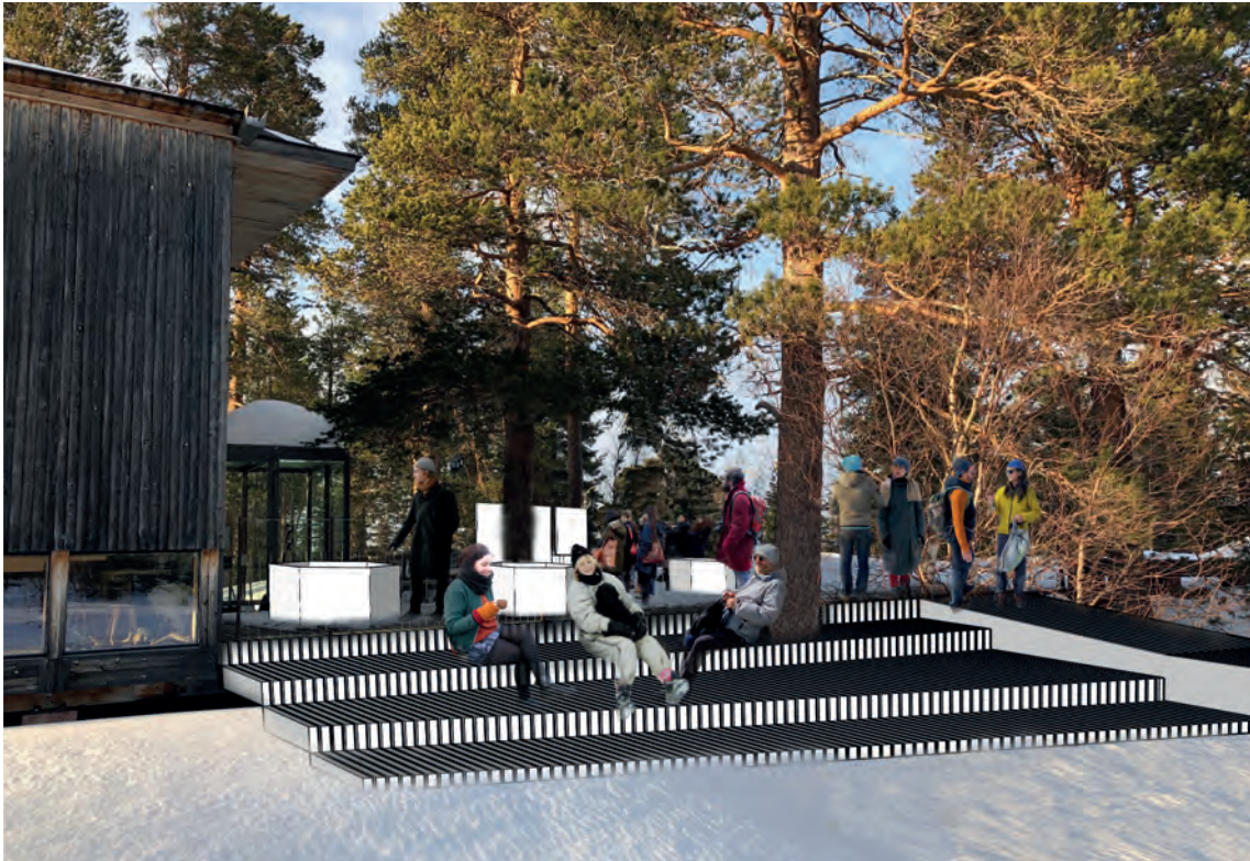
figur 58. Gradängens och entrétorgets volymer. Gradängen, torget och rampen byggs av tvärstående furuplankor.
