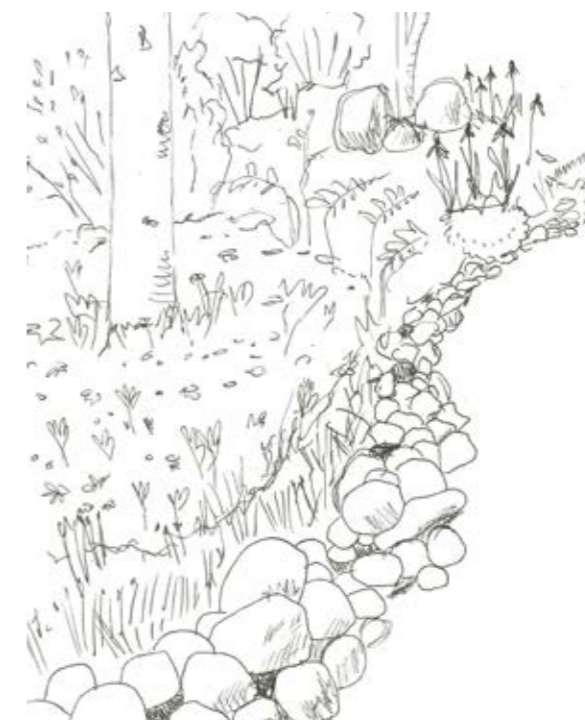
Figur 103. Skissen visar hur planteringarna är uppbyggda av lager av vegetation av perenner, buskar och träd vilket bidrar till en 'känsla av natur' och skapar många olika typer av habitat. En stenremsa i planteringen skapar habitat för insekter och smådjur samt skapar ett varmare mikroklimat runt sig, vilket bidrar till gynnsammare växtförutsättningar.
