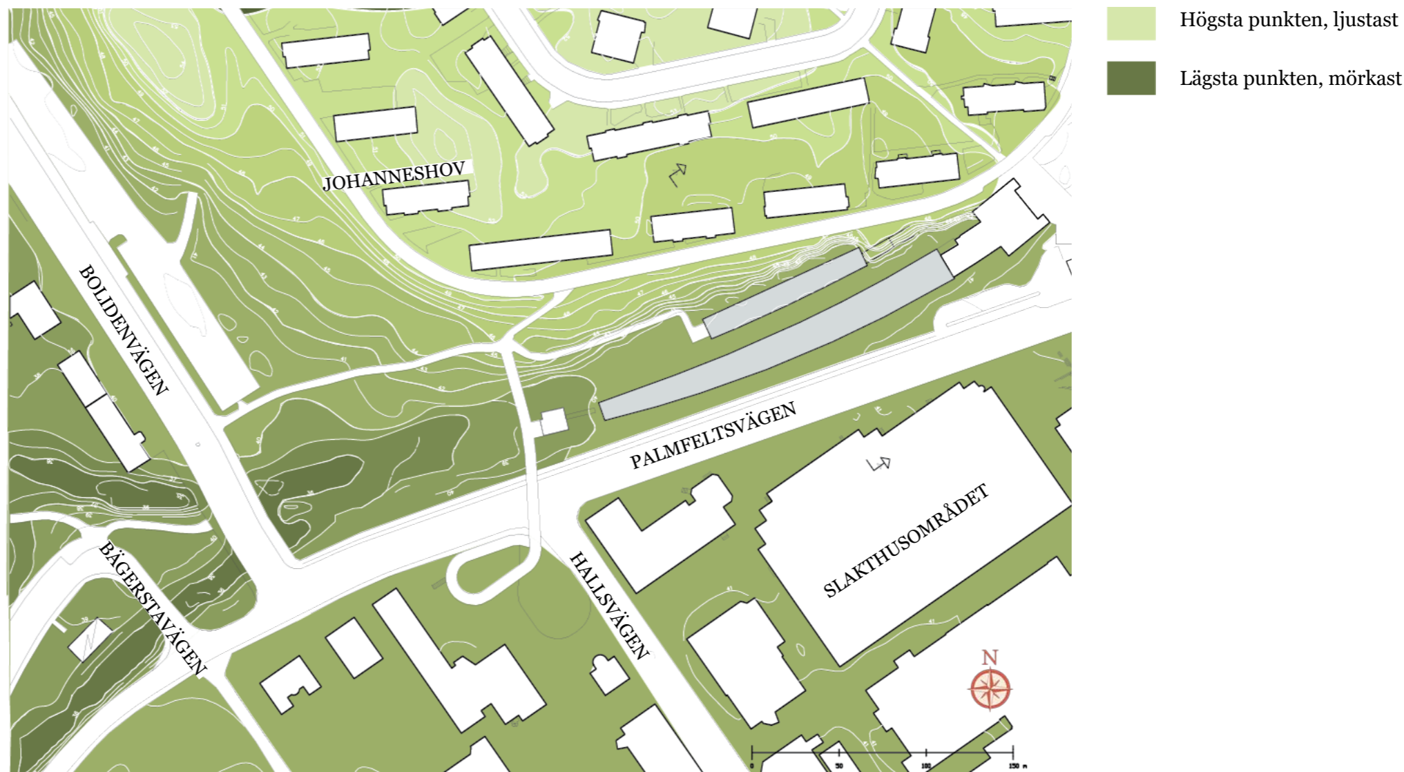
Figur 11. Topografisk karta som illustrerar hur höjdskillnaderna ser ut både inom samt utanför arbetsområdet. Skala 1:2000/A3. Dwg-underlag av © Stadsbyggnadskontoret, Stockholms stad. All illustration på dwg-underlaget är skapat av författarna.
