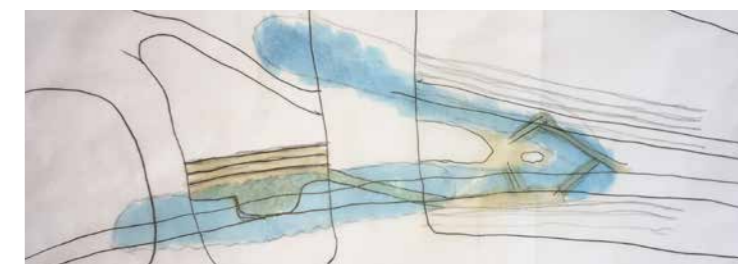
Figur 27. Skissen visar ett tidigt stadie där vi undersökte hur gångarna kan se ut över dagvattendammen och kopplas samman med sittpartiet på andra sidan Bolidenbron. Då utrymmet under bron bedömdes som mörkt och aningen osäker beslöt vi för att ta bort kopplingen under bron och arbeta vidare med de två sidorna separat.
