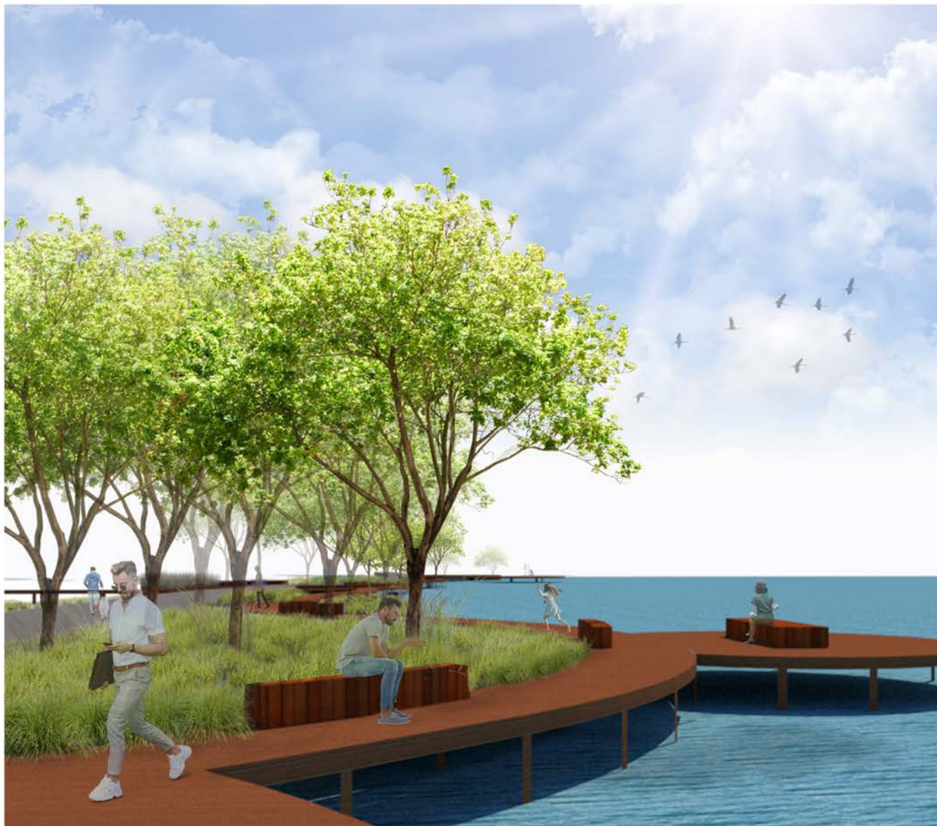
Bild 72. Perspektiv över träbryggorna som leder till Klarälven. Perspektivet visar hur spängerna leder ut till bryggor vid älven. Mycket av den befintliga naturen bevaras som består av ängsmark och träd. Vegetationen bidrar med omhändertagandet av regnvatten samtidigt som viktiga biotoper bevaras. Regnvattnet avleds naturligt till vegetationen, eftersom att dessa ytor är något nedsänkta i förhållande till gc-vägen. Ut med spängerna och bryggorna finns bänkar utplacerade där besökarna kan uppehålla sig. Bryggorna kommer att omges av räcken för att göra dem tillgängliga och säkra att använda för alla.
