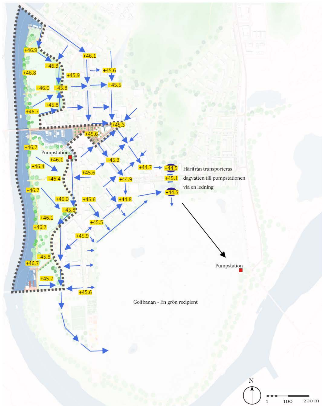
Bild 50. Visar Karlstad Kommuns (2018) förslag på flödesschema samt pumparnas placering. Bearbetad av författarna. 54
