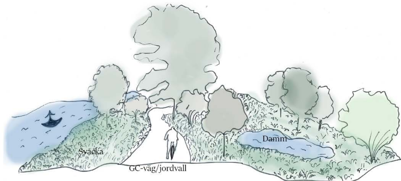
Bild 52. Illustration över strandpromenaden och regnbäddar. Det naturliga blandas med det moderna genom att svackor och dammar anläggs som smälter in i den befintliga naturen. Dessa varvas med upphöjda och nedsänkta regnbäddar som skapar dynamik.
