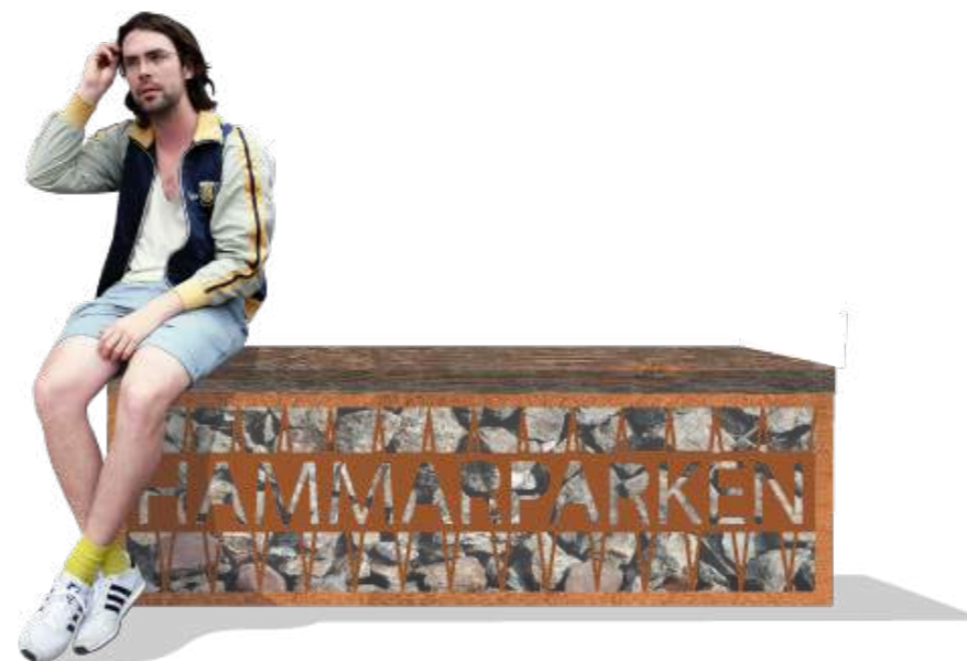
Figur 58: Detalj av bänk av corténstål som annonserar Hammarparken, bestående av en inburad kallmur med mönster inspirerat av koppen "Zebra" från Upsala Gefle Ekeby Porcelain.
