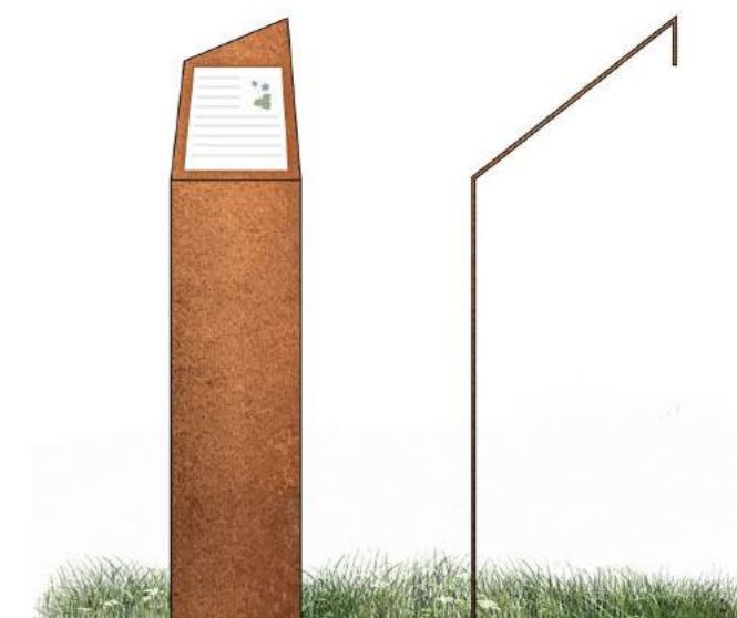
Figur 51: Detaljbild av informativt skyltprogram för Äventyrsstigen. Frontvy och sidovy. Skyltarna är av cortenstål och ger parkbesökarna information om vad som finns i skogen.
