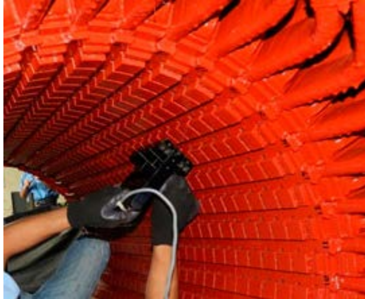
Figura 50. Forma de realizar la inspección de aflojamiento de cuñas, con un WTD-501.
