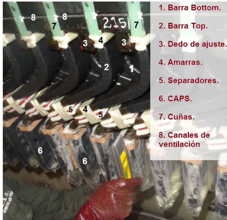
Figura 46. Zonas de inspección visual del devanado.
