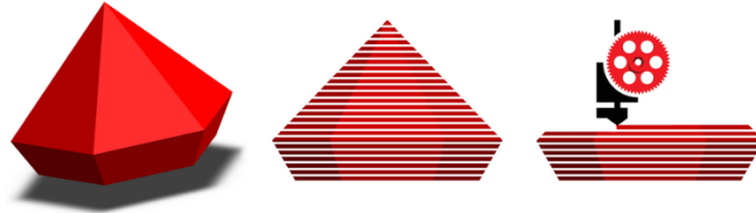
Figura 5. Fabricación mediante impresión 3D.
