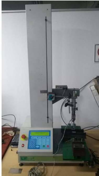
Figura 21. Máquina LF Plus universal, utilizada para las pruebas de flexión en 3 puntos.
