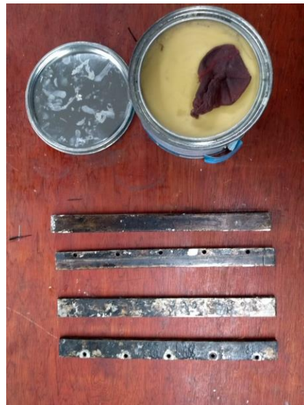
Figura 15. Cera desmoldante utilizada en el molde.
