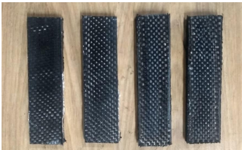
Figura 20. Probetas de CFRP obtenidas.
