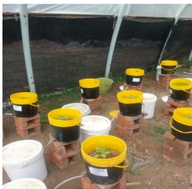
Figura 19. LD empleados para la recolección de nitrato lixiviado en plantas de estevia y albahaca.
