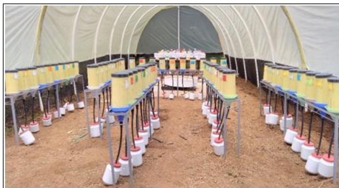
Figura 47. LD utilizados en la fase 1 del experimento para el estudio de proporciones de enmiendas. Cortesía: Ing Cindy Elejalde.
