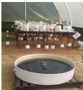
Figura 66. Tanque evaporímetro ubicado en el invernadero donde se llevó a cabo el experimento. Cortesía: Ing. Víctor Manuel Torres
