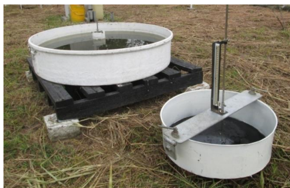
Figura 18. Calibración del tanque evaporímetro. Tanque de la estación meteorológica (izquierda) y tanque prototipo (derecha).
