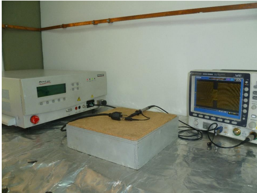
Figura 24. Hundimiento del 40 % durante 6 ciclos usando el equipo BEST EMC.
