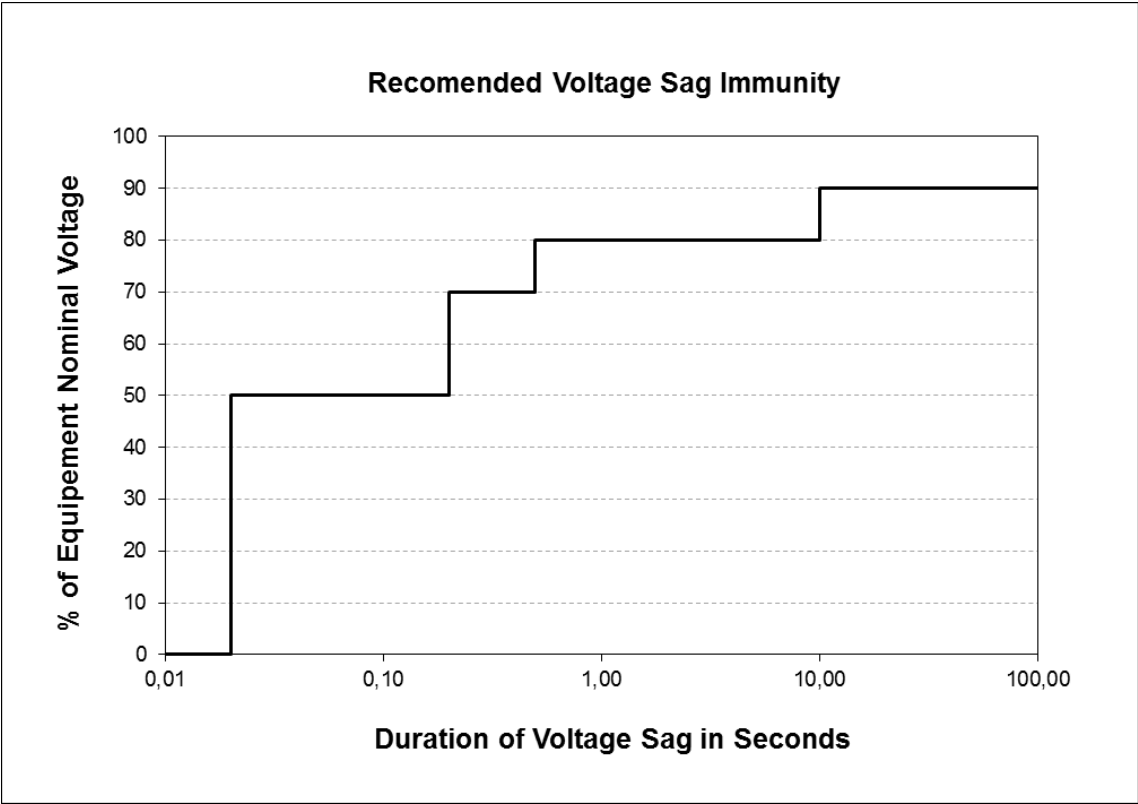
Figura 4. Curva SEMI F47 (Recomendación de inmunidad frente a hundimientos de tensión).
