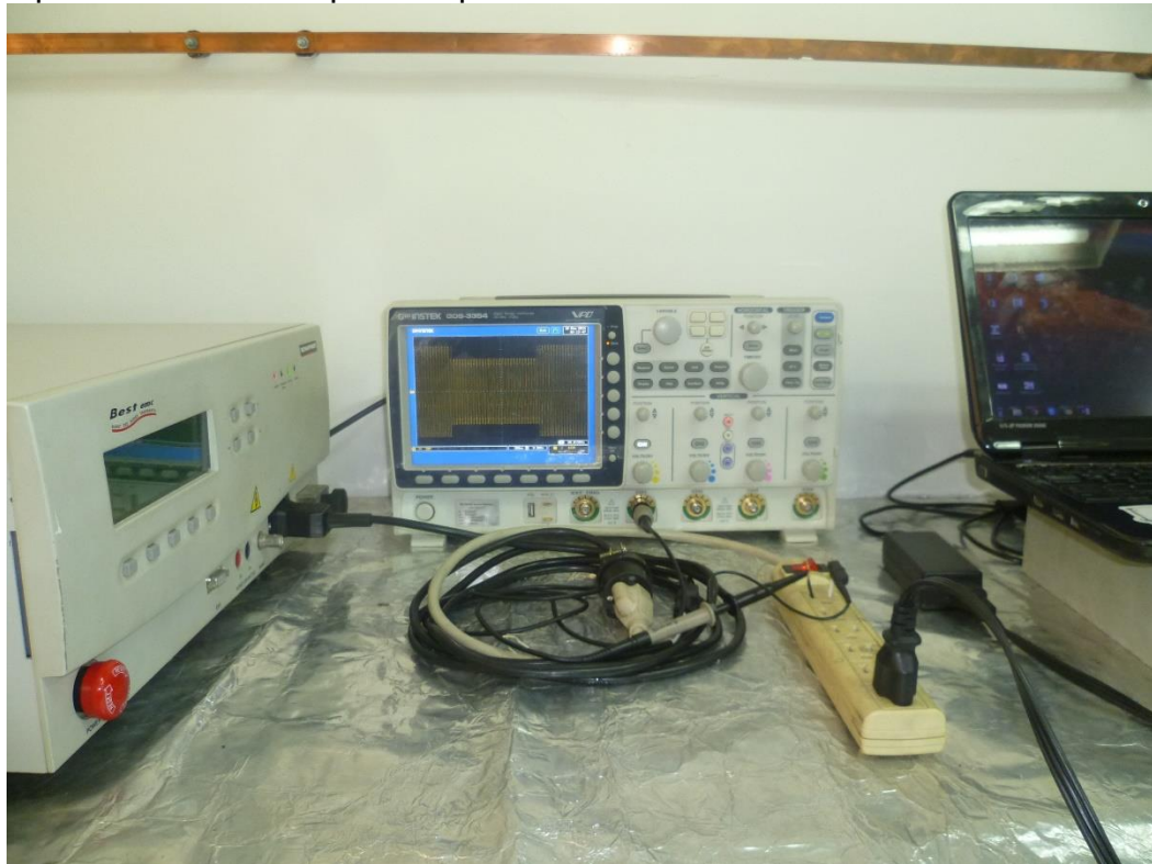
Figura 29. Montaje para el ensayo de inmunidad a hundimientos de tensión e interrupciones en un computador portátil.
