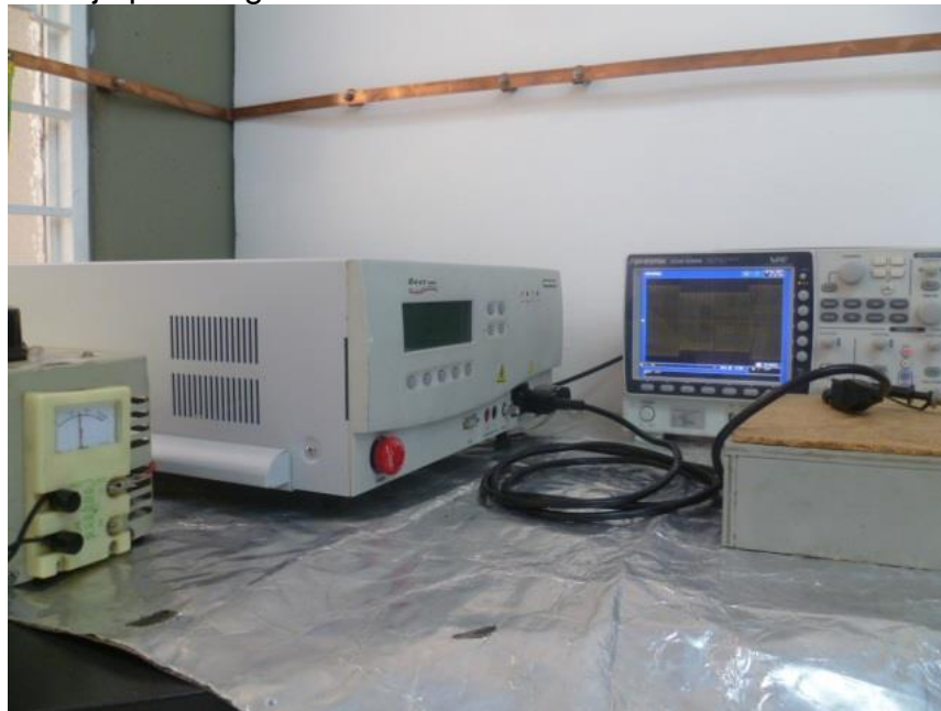
Figura 26. Montaje para la generación de un hundimiento tensión al 80 %.
