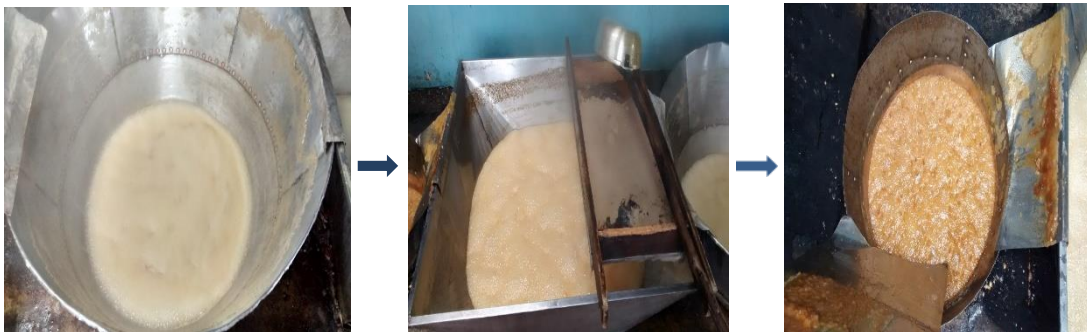
Figura 8. Evaporación y concentración de mieles
