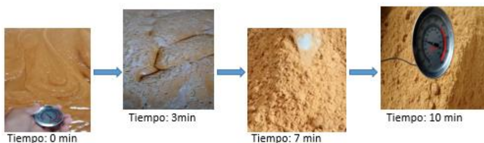
Figura 10. Proceso de elaboración de panela en la etapa de batido y reposo (T1:130°C)
