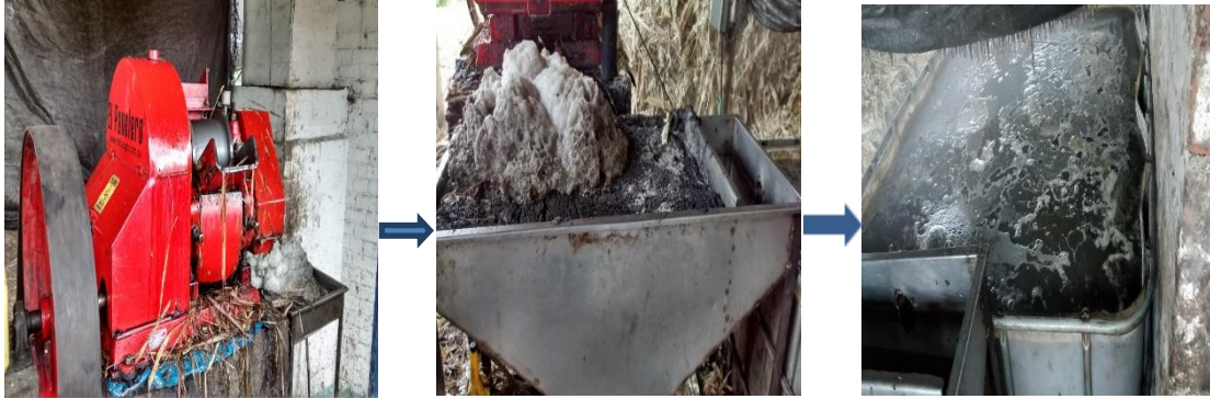
Figura 6. Extracción y prelimpieza de jugos
