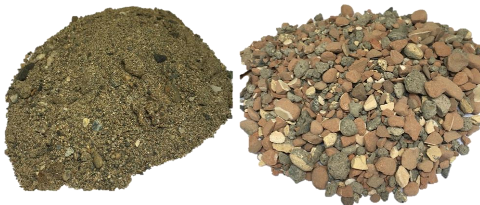
Figura 11. Tipos de arena utilizadas, arena natural (Izq.) y arena reciclada (Der.)
