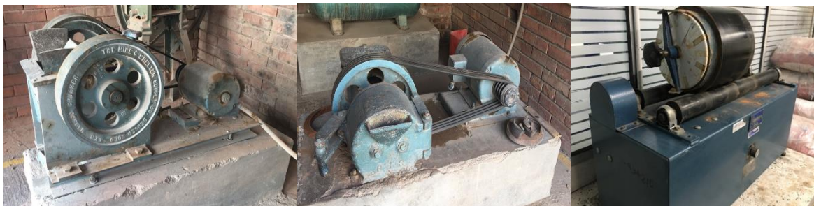
Figura 3. (a) Trituradora de mandíbulas, (b) Molino de discos y (c) Molino de bolas cerámicas.
