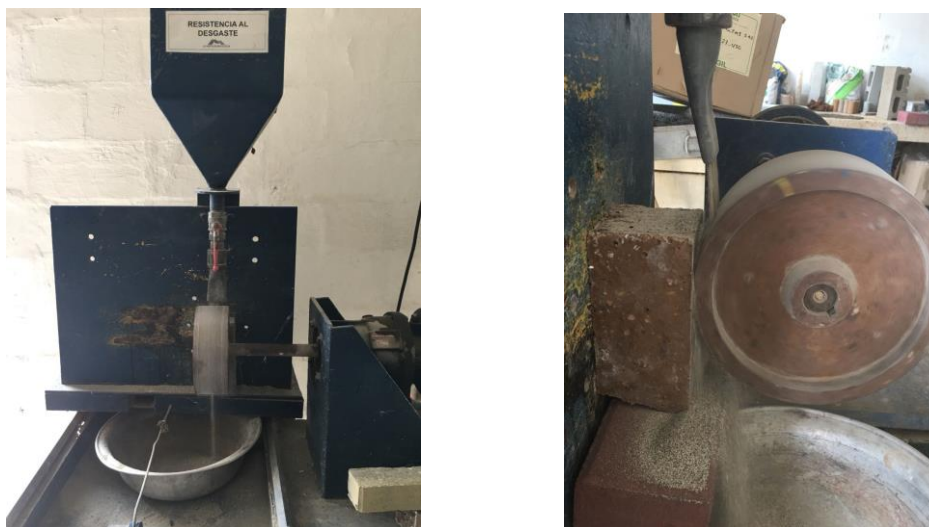
Figura 24. Montaje ensayo de desgaste abrasión NTC 5147.
