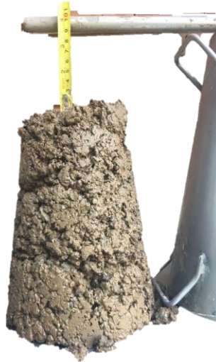
Figura 19. Slump obtenido para la mezcla 60/20/20 (500 Kg).
