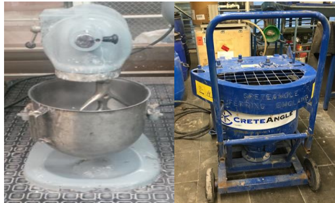
Figura 4. Equipos usado para la mezcla de pastas y morteros (a) HOBART Vulcan 1249, y de CAA (b) Mezcladora Planetaria CreteAngle.
