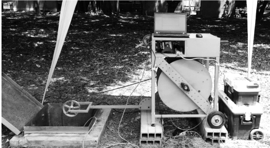
Figura 6. Unidad de ensayos móvil instalada en la perforación de estudio.
