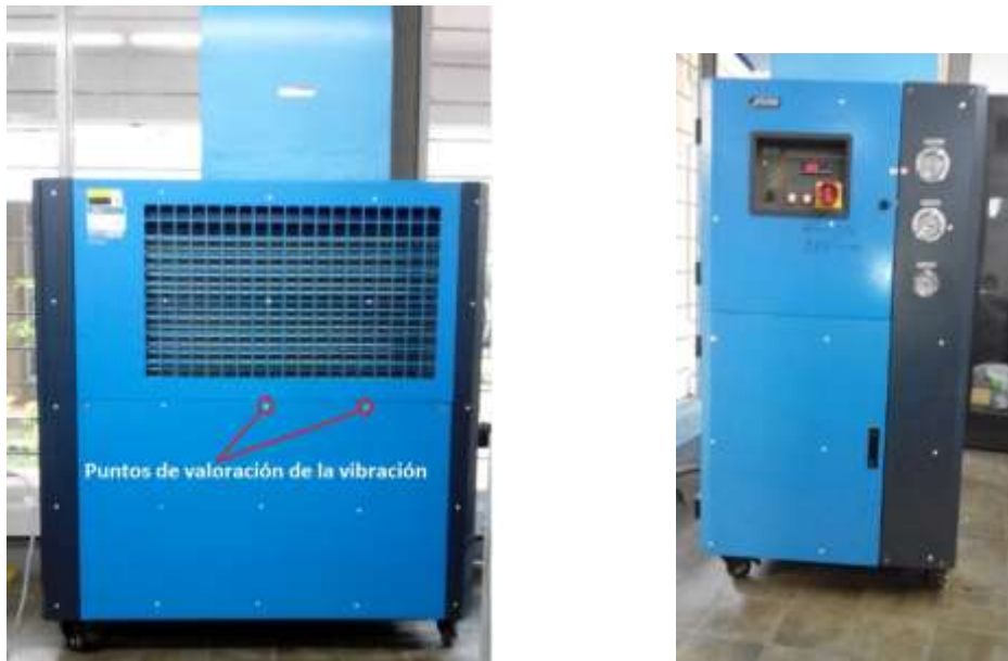
Figura 11. a) modelo del chiller; b) puntos de valoración de la vibración en la cara 1 y 2 del chiller.
