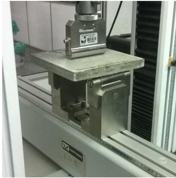
Figura 21. Montaje del ensayo a flexión para baldosas
