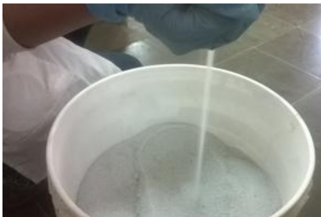
Figura 18. Arena-Vidrio, como reemplazo de la arena natural para la producción de morteros
