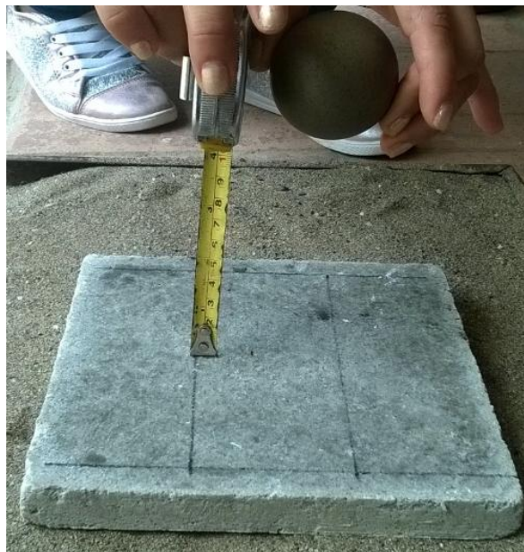
Figura 23. Montaje del ensayo de impacto o resistencia al choque de baldosas
