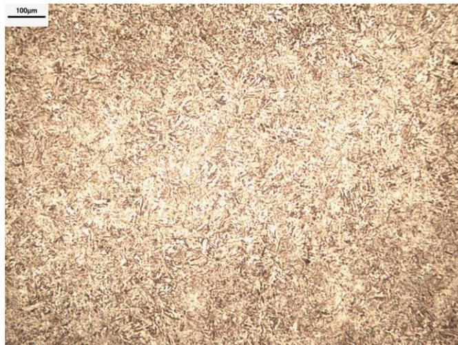
En la figura 23 se observa una microestructura más acicular comparada con la microestructura de la figura anterior [figura 22](#). Comienzan a nuclear precipitados de cementita y la martensita de bajo carbono pierde su tetragonalidad y se convierte en ferrita BCC [34].
