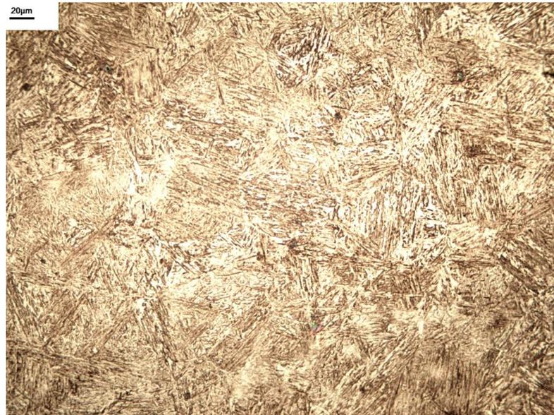
En la figura anterior (Figura 22) se observa una estructura acicular que corresponde a martensita revenida y también presenta austenita retenida (zonas claras). Esta microestructura es la más dura y mecánicamente más resistente en comparación con las revenidas a 400°C y 600°C, presenta la mayor resistencia a la nucleación de grietas por fatiga y la mayor resistencia a la fatiga.
