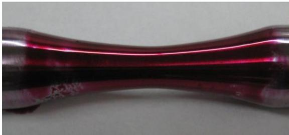
Pasado los 15 minutos se procedió a remover el exceso de tinta de la superficie, posteriormente se aplicó el revelador como se aprecia en la figura 20 y se esperó aproximadamente 10 minutos con el objetivo de que el revelador absorbiera la tinta alojada en alguna grieta hasta la superficie.
