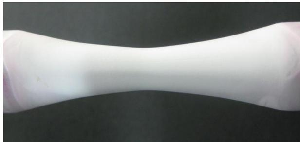
El último paso del procedimiento consistió en examinar visualmente las grietas formadas en la superficie, de no ser así se procedía a limpiar completamente la superficie de la probeta para continuar con el ensayo de fatiga con corrosión. En la figura anterior no se observó ninguna nucleación de grieta por lo tanto fue necesario repetir el procedimiento desde el principio hasta que se hallara una grieta.
