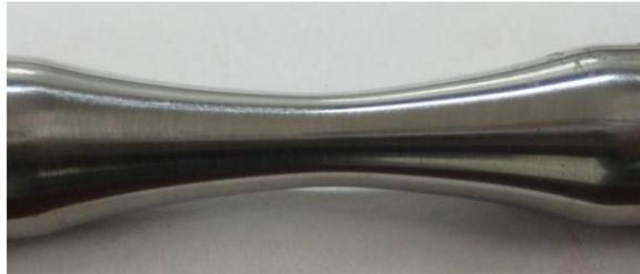
Posteriormente se aplicó la tinta penetrante sobre toda la superficie de la zona central de la probeta como se observa en la figura 19. Se esperó 15 minutos con el fin de que la tinta pudiera ingresar en las grietas que se hubieran formado.
