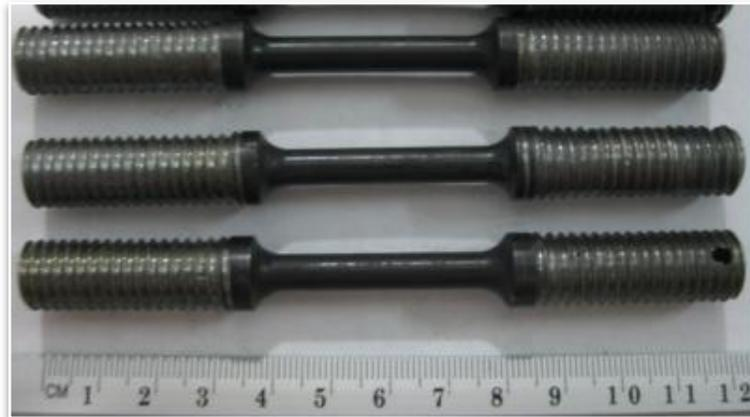
Se contaron con 9 probetas para realizar los ensayos de tensión, pero debido a que 6 probetas se les había realizado un recocido para disminuir la dureza, se debía realizar de nuevo el temple y revenido a sus temperaturas correspondientes (200°C a 3 probetas y 400°C a 3 probetas). Con todas las probetas listas con sus respectivos tratamientos térmicos y con rosca a ambos extremos se procedió a realizar los ensayos.
