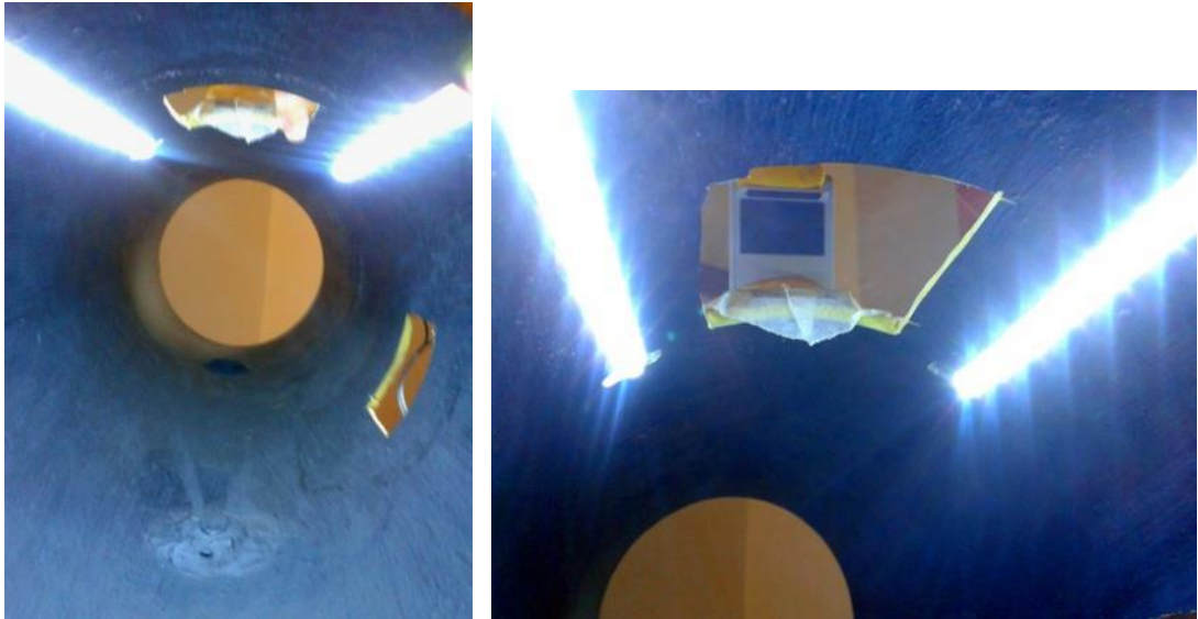
Figura 3.6 Sistema de iluminación para la captura de imágenes
