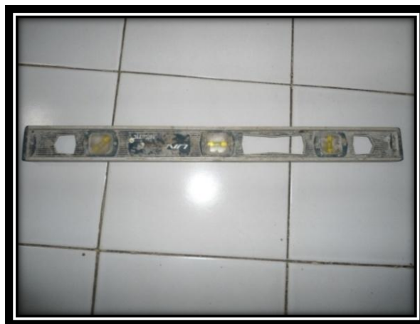
Gambar 63: Waterpas (Sumber: Dokumentasi Basrullah, 2012)
