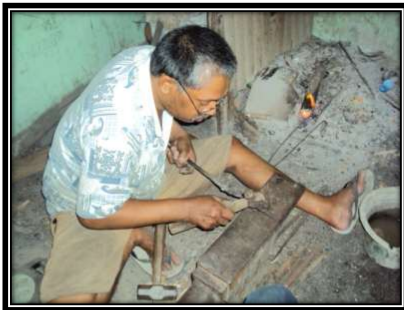
Gambar 32: Proses Penempaan Bilah Sumber: Dokumentasi Rahmat, April 2012
