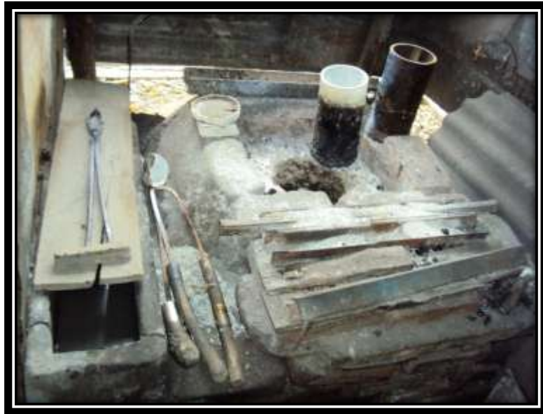
Gambar 27: Alat untuk membuat rencong dengan teknik cor Sumber: Dokumentasi Rahmat, April 2012
