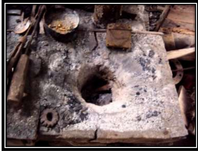
Gambar 29: Tungku untuk mencairkan kuningan Sumber: Dokumentasi Rahmat, April 2012
