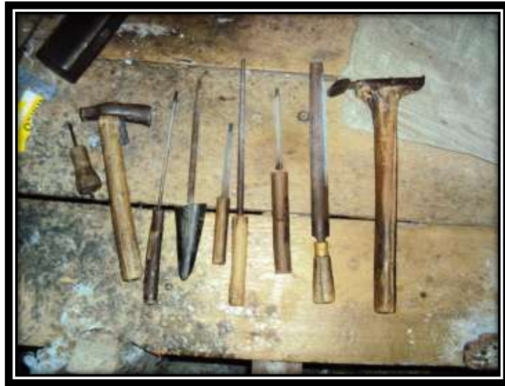
Gambar 26: Peralatan yang digunakan dalam pembuatan rencong Sumber: Dokumentasi Rahmat, April 2012
