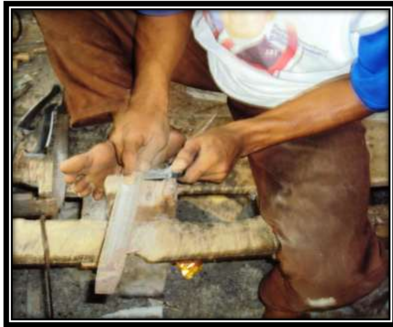
Gambar 36: Proses Pembuatan Gagang dari Bahan Kayu Keumuneng Sumber: Dokumentasi Rahmat, April 2012
