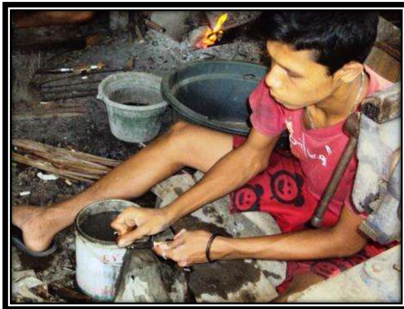
Gambar 39: Proses Finishing Menggunakan daun Kuda-Kuda Sumber: Dokumentasi Rahmat, April 2012
