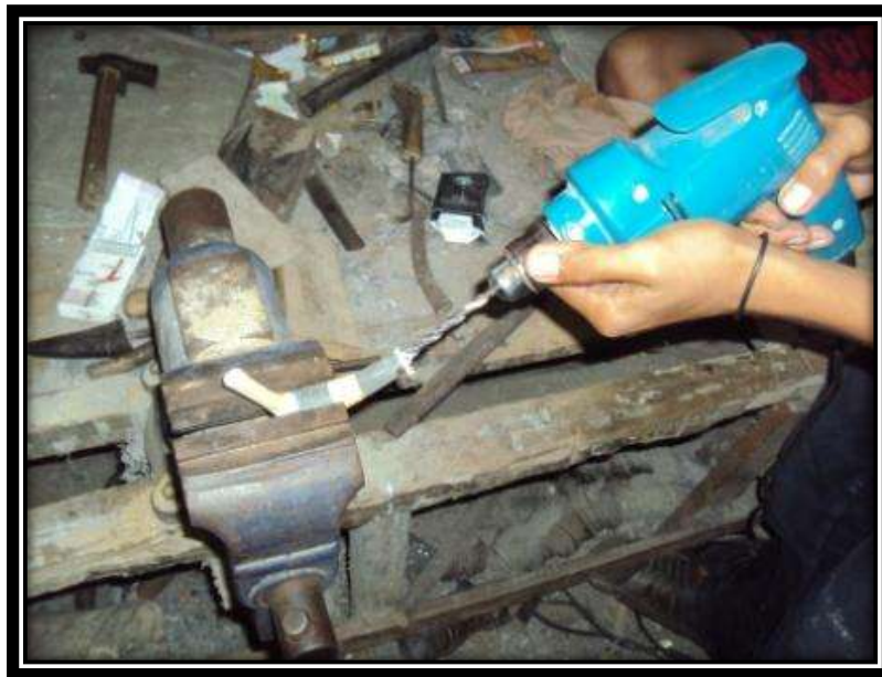
Gambar 35: Proses Melubangi Gagang Sumber: Dokumentasi Rahmat, April 2012
