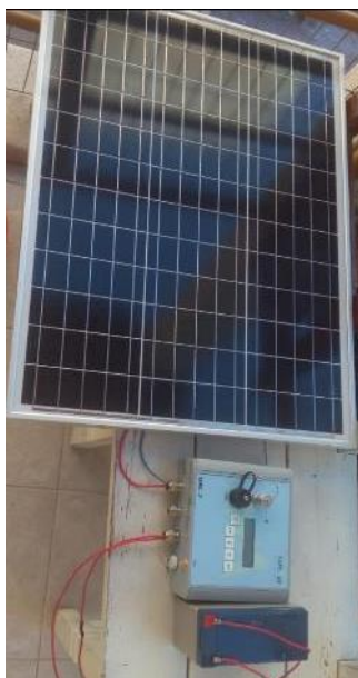
Figura 7: Panel solar, datalogger y batería
