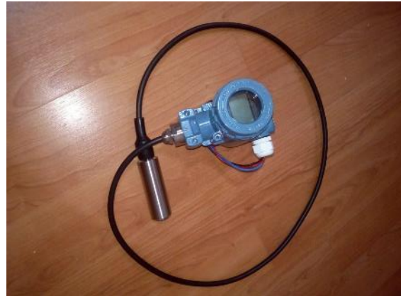
Figura 6 transductor de presión que mide altura de agua
