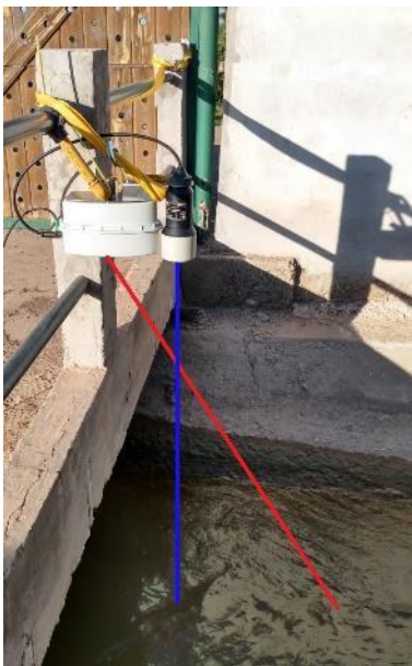
Figura 3: Pruebas de medición para su calibrado. En rojo, onda radar de velocidad superficial y en azul, radar de altura del tirante de agua
