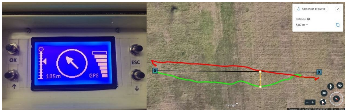
Figura 3: Izq. Pantalla de Guiado. Der. Trayecto ensayado, línea teórica entre dos puntos (color negro) y desvío máximo registrado en la trayectoria
