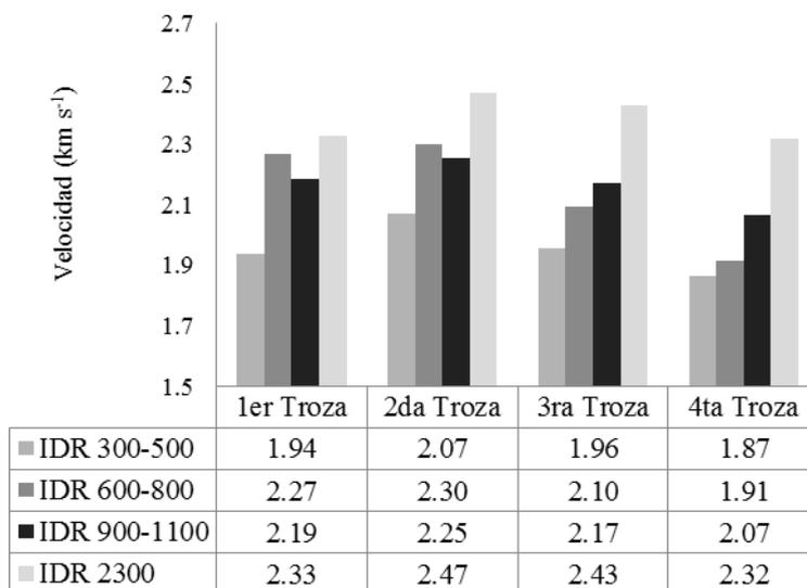
*Figura 1. Velocidad de propagación de onda acústica (km s<sup>-1</sup>) en trozas de pino ponderosa según la densidad de manejo establecida en rango de Índice de Densidad de Rodal de Reineke (IDR). La primera troza corresponde a la base del árbol. IDR: 300-500; 600-800; 900-1100 y 2300 (Testigo). Ea. Sta. Lucía, Meliquina, Neuquén.*
