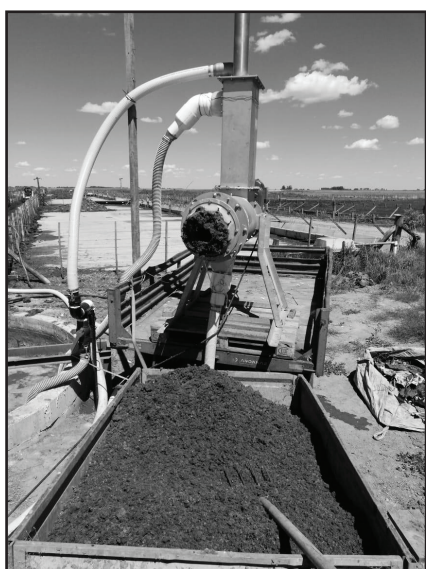
Figura 7: Separador de sólidos y efluentes de estiércoles de feedlots y tambos.
