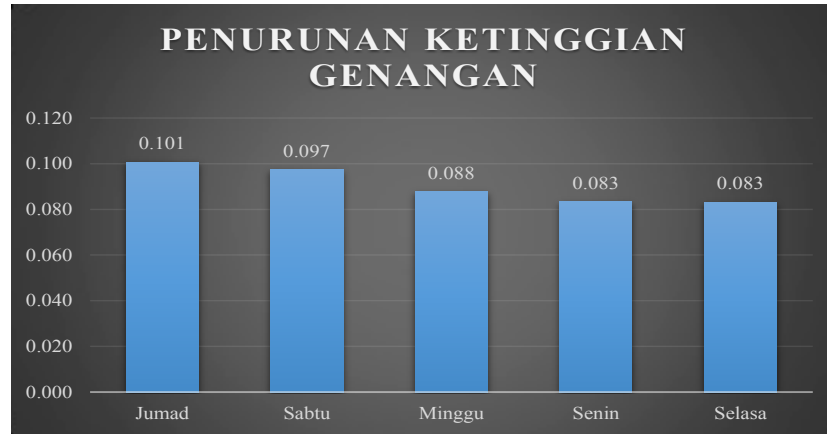
Gambar 6. Penurunan Ketinggian Genangan per 1 Menit untuk Setiap Hari di Gerbang Akses
