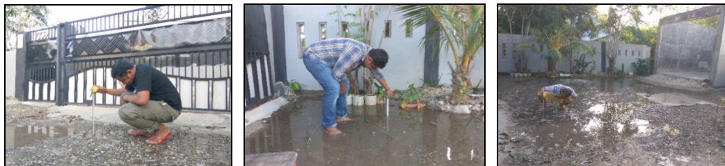
Gambar 2. Pengukuran Penurunan Ketinggian Genangan di Gerbang Akses dan Pojok Halaman
