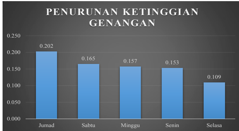
Gambar 5. Penurunan Ketinggian Genangan per 1 Menit untuk Setiap Hari di Pojok Halaman
