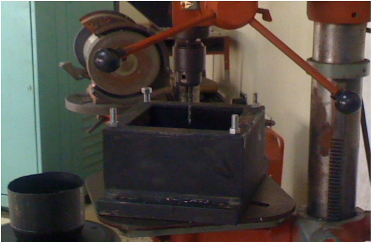
Figura 7. Adecuación de Maquina de Impactos. Optimización de Base de Soporte de Muestras.
