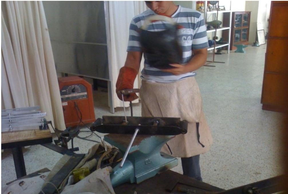
Figura 14. Aplicación de Soldadura a estructura de inductador.
