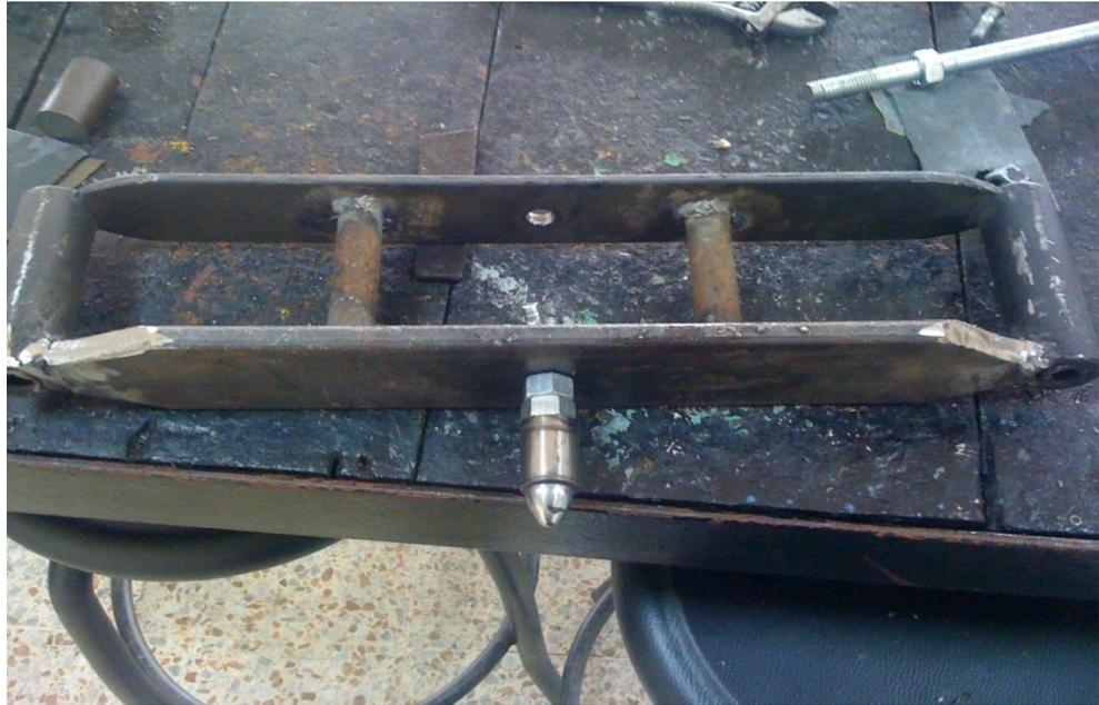
Figura 15. Estructura de soporte con Indectador
