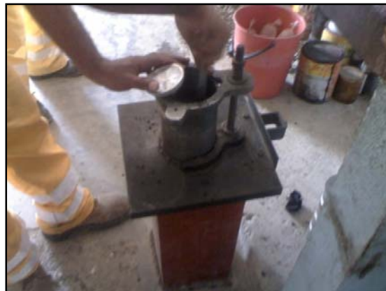
Figura 25. Preparación del Molde donde se Depositará la Mezcla Asfáltica
