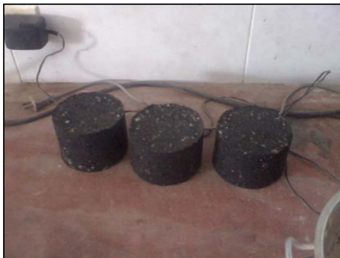
Figura 19. Muestras para Ensayo Marshall – Briquetas de Asfalto
