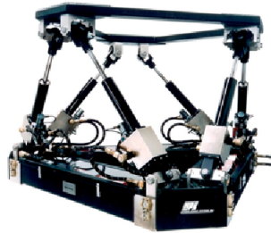
Figura 2.3: Ejemplo de un robot de una plataforma de Stewart-Gough. Tomado de Motion Systems
