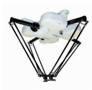
Figura 2.1: Robot Paralelo Delta. Tomado de la pagina www.interempresas.net
