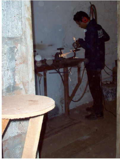
Afilador sin careta o gafas transparentes que le permita cubrir sus ojos de las chispas.
