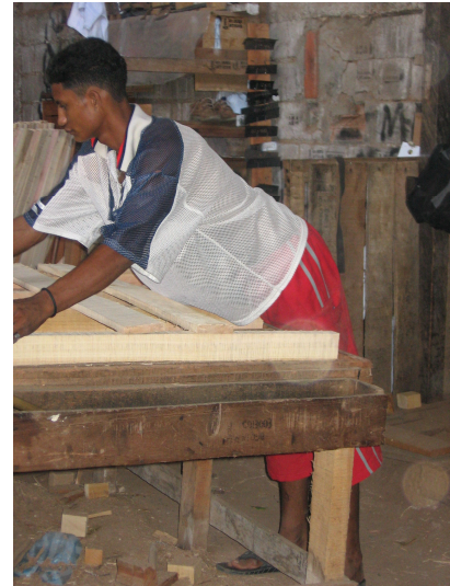
Estibador sin uniforme, en chanclas y sin elementos de protección personal.
