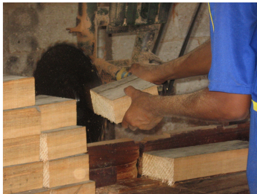
Corte de tacos en la Sierra de Péndulo sin elementos que protejan la mano del operario.
