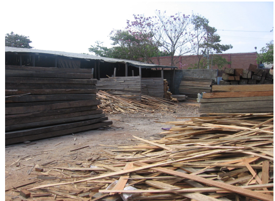
Espacios no definidos para la materia prima y los desperdicios, además se evidencia la falta de pavimentación del piso de la planta.
