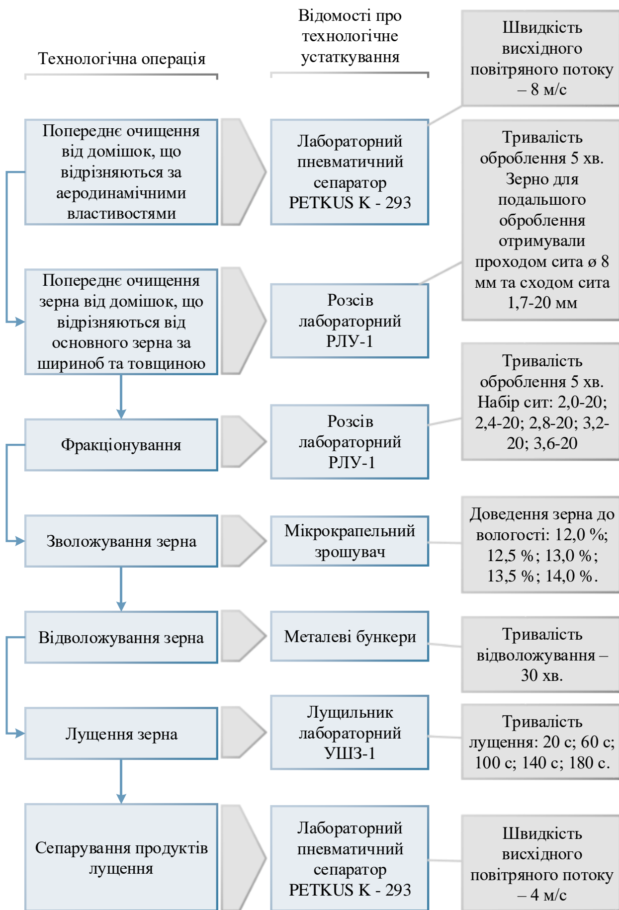
Рис. 1. Принципова схема виробництва крупи ліщеної в лабораторних умовах
