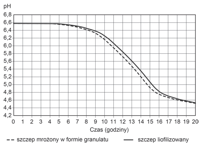
Rys. 2. Krzywe ukwaszania mleka przez kultury starterowe w postaci mrożonej i liofilizowanej
