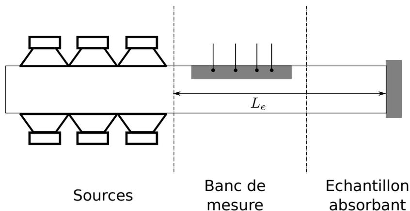
FIGURE 1 – Présentation schématique du SKT (vue en coupe). - Montage expérimental : 12 H.P Beyma 10LW30/N - Tube de diamètre 20mm - Position relatives des microphones ( $x_2 - x_1 = 20$  mm ;  $x_3 - x_1 = 431$  mm ;  $x_4 - x_1 = 590$  mm ).
